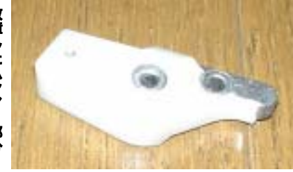
故障したハンマー部分
